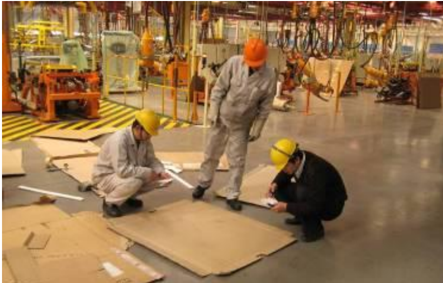
Prototypage de machines en carton pour simuler un processus.
